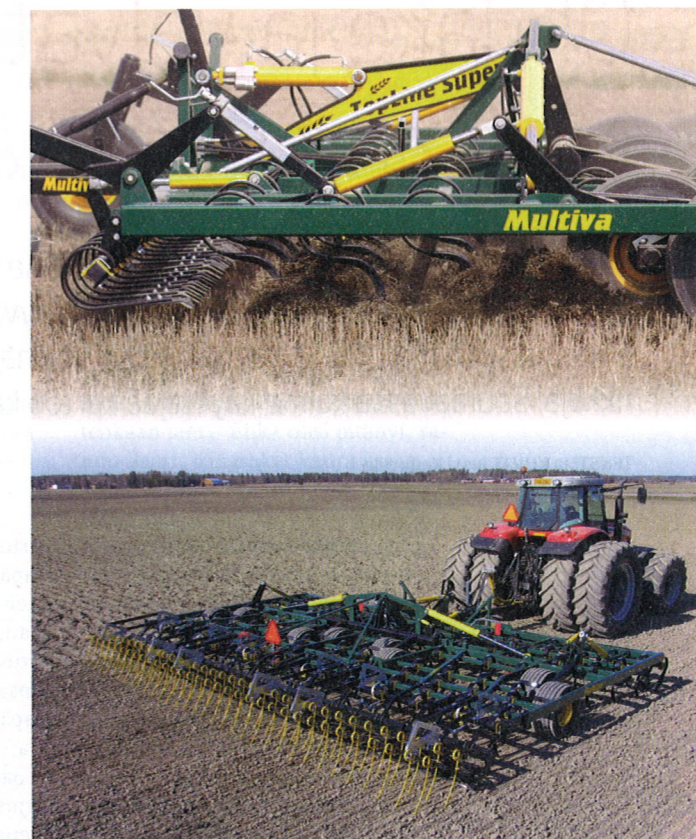
Samalla Multiva TopLine Super -äkeellä voidaan hoitaa kylvömuokkaus ja sänkimuokkaus keväällä sekä olkiaestys syksyllä.
